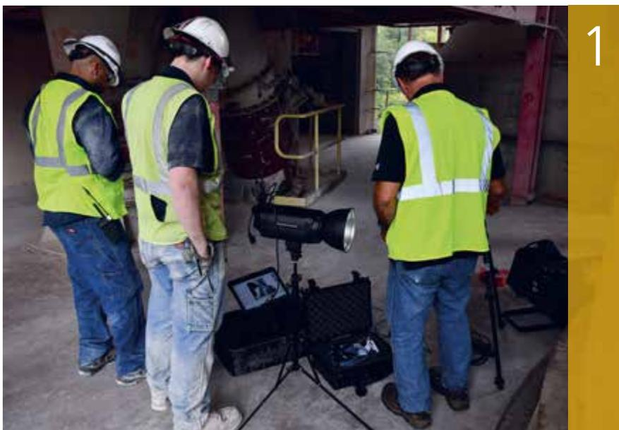
1. I TECNICI SI PREPARANO A FILMARE LA CRESCITA TERMICA DI UN CONDOTTO DI SCARICO.
